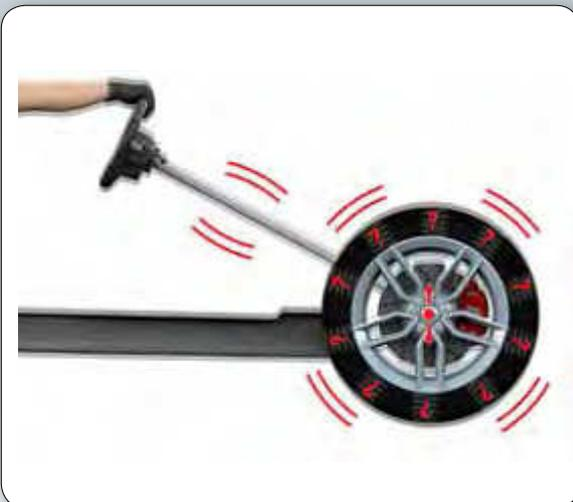
Die Vibration wird von den Rädern, über die Lenkung, zum Lenkrad übertrage
