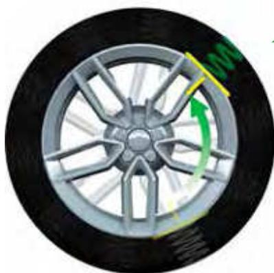
Die Road Force Touch Wuchtmaschine ordnet beide Werte, nach der Match Methode der Hersteller, zueinander.
