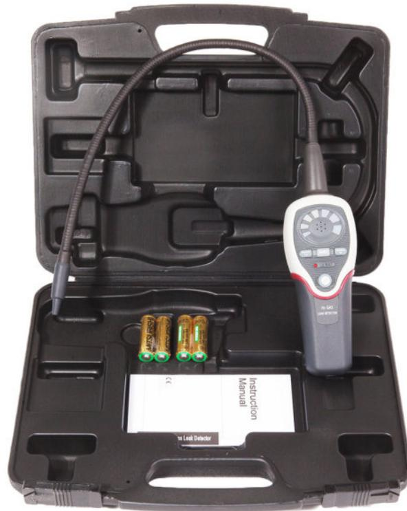
Für die elektronische Ortung von Leckagen an Klimaanlage mit Kältemittel R 134a, R 1234yf, R 404a, R 407c, R 22, Wasserstoff u.a.
