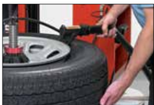
Le canon d'air dirige un jet d'air comprimé pour coller les talons difficiles.
