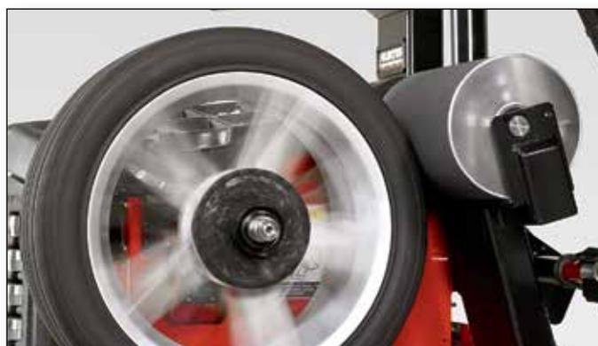
Le changeur de pneus Maverick™ utilise des rouleaux qui permettent de tourner le pneu sur la jante pour appairer le point rigide du pneu au point bas de la jante.
