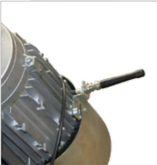
Durch die **Funksteuerung** sind keine Verbindungskabel zwischen den Säulen nötig. Die Rüstzeiten zum Verkabeln der Säulen miteinander entfallen.
