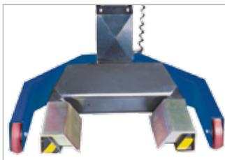
Durch Aufsetzen von Einlegepratzen können auch Fahrzeuge mit kleinerem Raddurchmesser aufgenommen werden.
