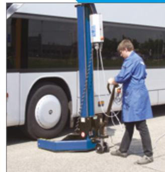
Komfortable Bedienung mittels robuster Folientastatur (Auf, Ab, Einzel- und Gruppenbetrieb möglich).
