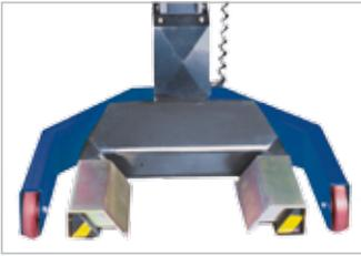
Durch Aufsetzen von Einlegespritzensätzen können auch Fahrzeuge mit kleinerem Raddurchmesser aufgenommen werden.
