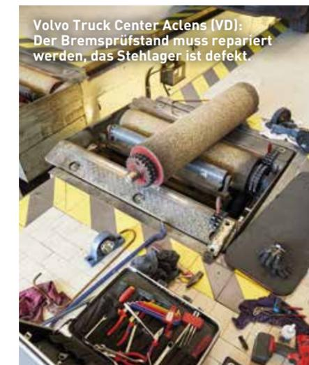
Volvo Truck Center Aclens (VD): Der Bremsprüfstand muss repariert werden, das Stehlager ist defekt.
