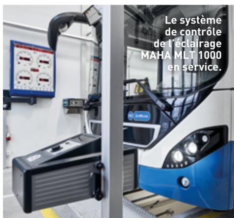
Le système de contrôle de l'éclairage MAHA MLT 1000 en service.
