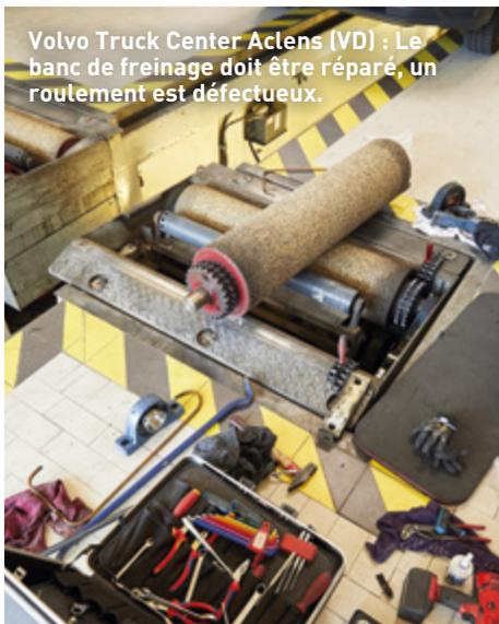
Volvo Truck Center Aclens (VD) : Le banc de freinage doit être réparé, un roulement est défectueux.
