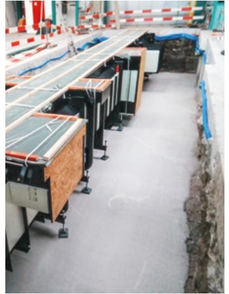
La fosse de finition a été mise en place sur les fondations déjà préparées grâce à la grue de la halle.
