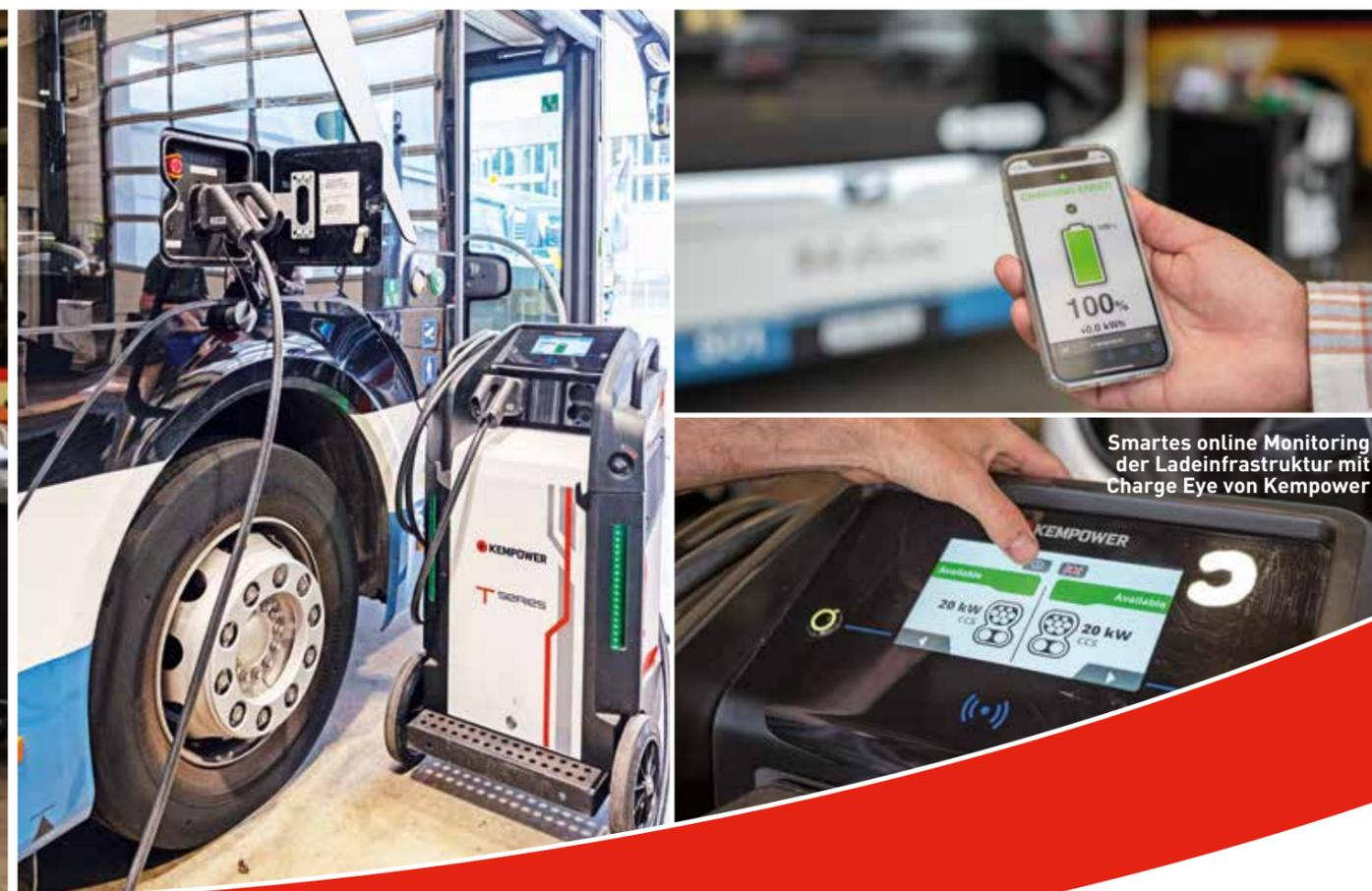
Smartes online Monitoring der Ladeinfrastruktur mit Charge Eye von Kempower
